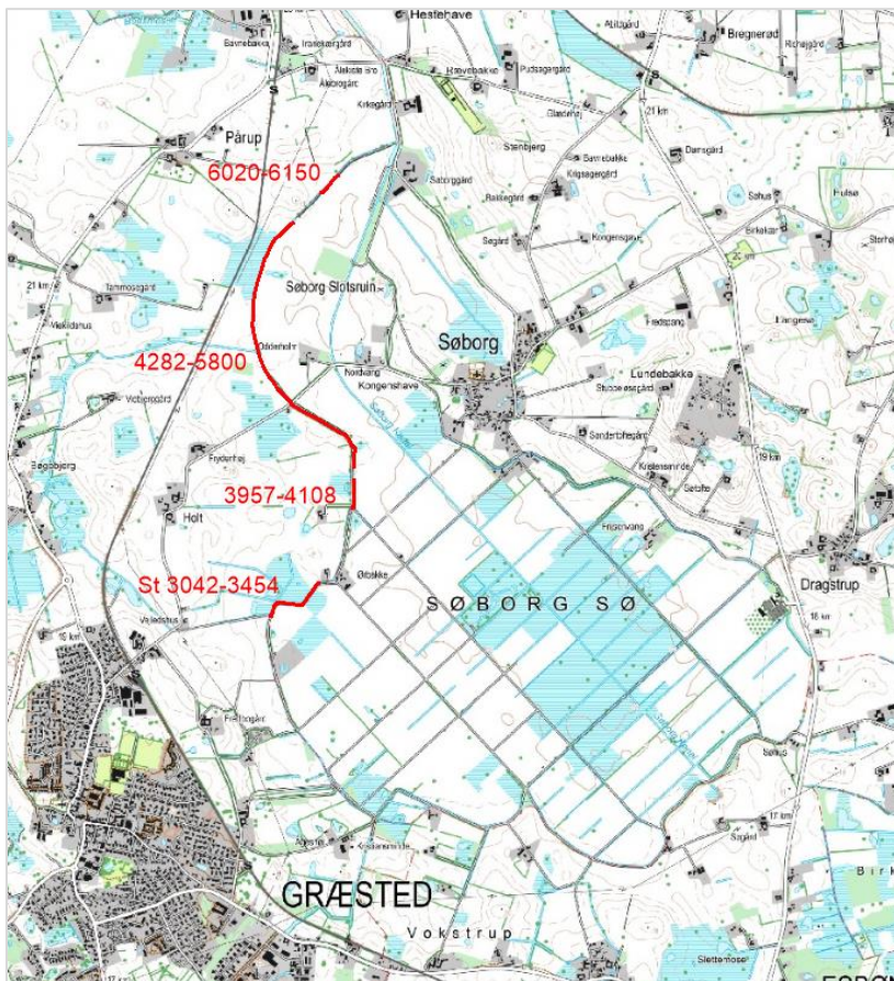
Figur 2-7. Eksisterende 4 diger, der vedligeholdes af Landvindingslaget Søborg Sø.
